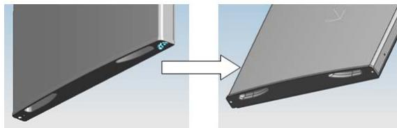
C. Rimuovere l'altro blocchetto della porta con la relativa vite di fissaggio.
