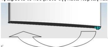
6. Αφαιρέστε και τοποθετήστε στην άλλη πλευρά τον κάτω μεντεσέ και μετά στηρίξτε το με τις βίδες.
