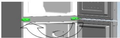
8. Regolare la posizione della porta inferiore a destra, fissare la cerniera intermedia.
