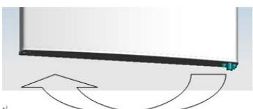
6. Udskift det nederste hængsel til den anden side, og fastgør det så med skruer.
