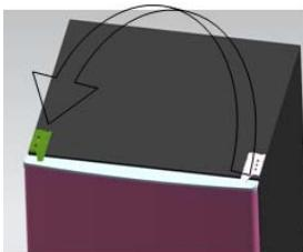
10. Sett øvre dør i høyreposisjon og fest topphengselet og dekselet.
