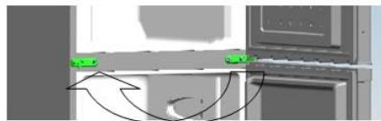
8. Stellen Sie die Position der Tür unten rechts ein und befestigen Sie das mittlere Scharnier.
