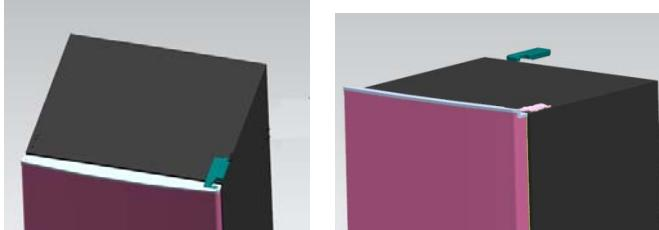
2. Retirez les vis de fixation de la charnière supérieure à l'aide d'un tournevis cruciforme.
