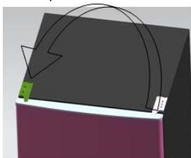
10. Установить верхнюю дверцу в нужное положение, закрепить верхнюю петлю и крышку.
