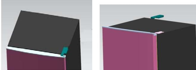
2. Rimuovere le viti che fissano la cerniera in alto usando un cacciavite a stella.
