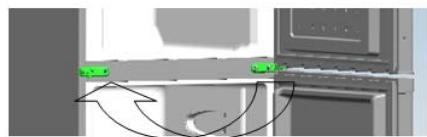
8. Ajuste la posición derecha de la puerta inferior y fije la bisagra central.
