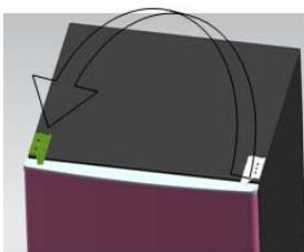
10. Stellen Sie die obere rechte Türposition ein, befestigen Sie das obere Scharnier und die Abdeckung.
