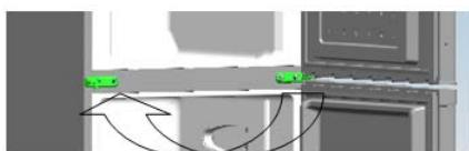
8. Indstil den nederste dør i korrekt position, fastgør det midterste hængsel.
