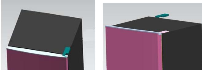
2. Ta bort skruvarna som fäster det övre gångjärnet med en stjärnskruvmejsel.
