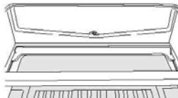
Ovodni otvor imat će umetnut „šiljak za čišćenje“. Na ovaj način sitni komadi hrane ne mogu ući u odvod. Nakon što ste očistili unutrašnjost vašeg hladnjaka i uklonili bilo kakve ostatke hrane oko otvora upotrijebite „šiljak za čišćenje“ kako biste bili sigurni da nema blokada. Upotrijebite standardno sredstvo za poliranje namještaja za čišćenje vanjske strane hladnjaka/zamrzivača.
