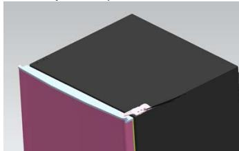
3. Namontujte horní závěs a blok omezení horních dveří a pouzdro ložiska dveří na druhou stranu.
