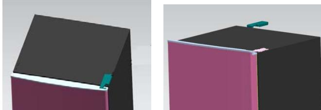
2. Îndepărtați șuruburile care fixează balamaua folosind o șurubelnită cu cap în cruce.
