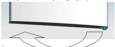
6. Mutati balamaua de jos pe partea opusă a ușii și fixați-o cu șuruburi.
