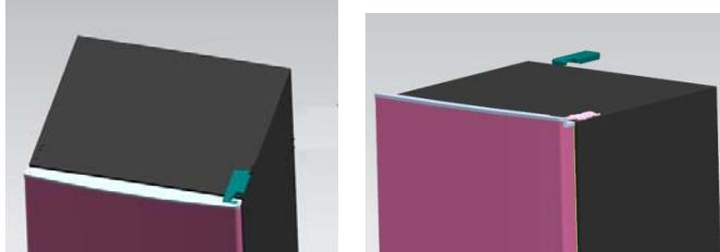
2. Retire os parafusos que fixam a dobradiça superior com a chave de fendas cruzada.
