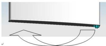
6. Bringen Sie das untere Scharnier auf der gegenüberliegenden Seite an und befestigen Sie dieses mit Schrauben.
