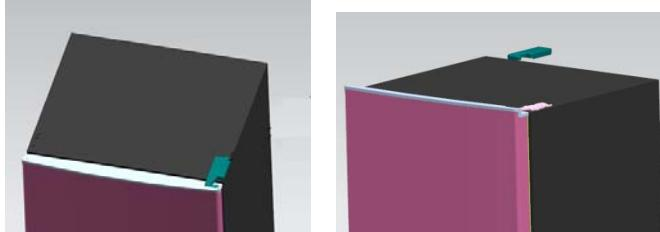
2. Entfernen Sie die Befestigungsschrauben des oberen Scharniers mit einem Kreuzschlitz-Schraubendreher.
