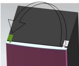
10. Ajuste la posición derecha de la puerta superior; luego fije la bisagra superior y la tapa.
