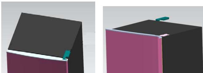
2. Bruk en kryssporskruttrekker for å fjerne skruene i det faste topphengselet.
